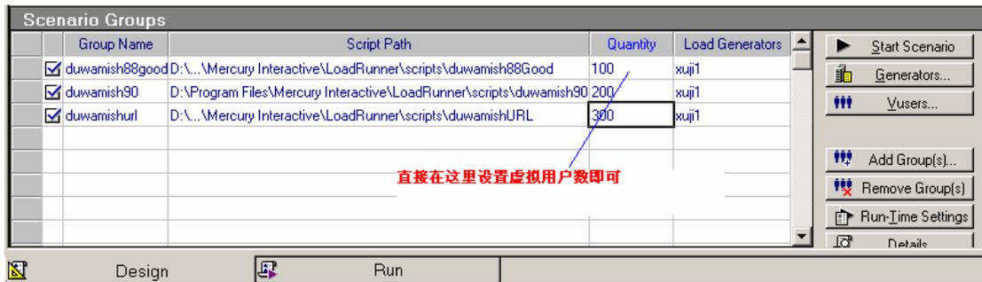
点右边的“VUsers”按钮即可设置，该虚拟用户将在那个 Load Generators 上运行。
