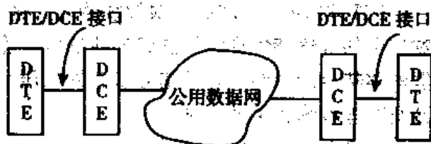
图 3-1 DTE - DCE 接口框图
